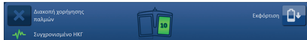
Εικόνα 8.7.4: Εικονίδιο διπλού ποδοδιακόπτη - Επισημασμένος δεξιός ποδοδιακόπτης
