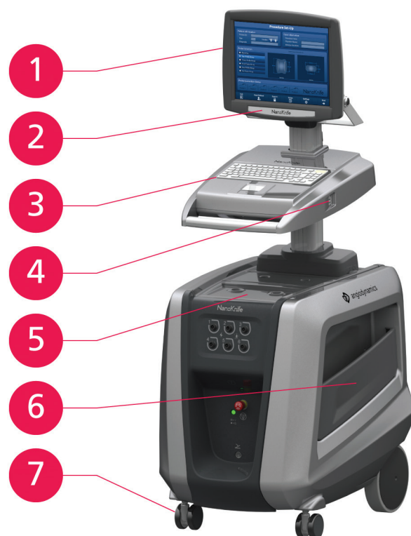
Figura 3.2.1: Gerador NanoKnife – Componentes do lado dianteiro e direito
