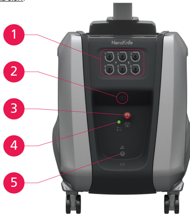
Figura 3.3.1: Gerador NanoKnife – Componentes dianteiros inferiores
