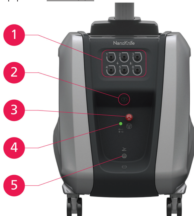
Obrázek 3.3.1: Generátor NanoKnife – komponenty jsou při pohledu zředu umístěny ve spodní části přístroje
