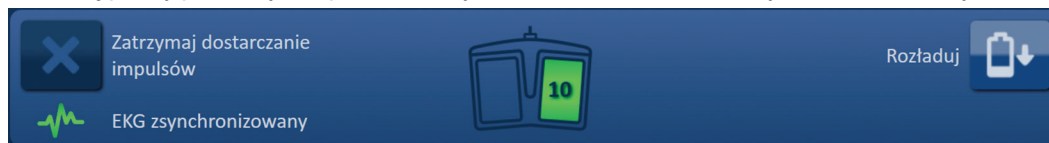
Rysunek 8.7.15: Ikona przełącznika nożnego z dwoma pedałami — prawy pedał podświetlony
