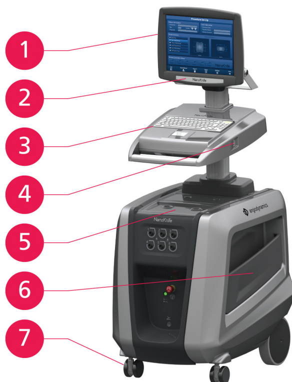
Rysunek 3.2.1: Generator NanoKnife — elementy na przodzie / po prawej stronie
