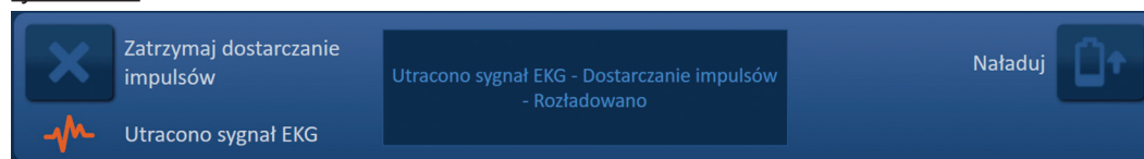
Rysunek 10.6.3: Sygnał EKG utracony podczas dostarczania impulsów — rozładowano
