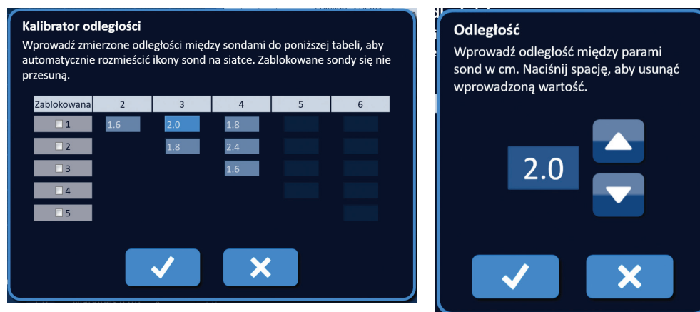
Rysunek 7.7.3: Kalibrator odległości — okno podręczne Odległości między parami sond
