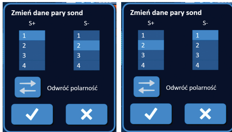
Rysunek 7.5.7: Odwrotna polarność pary sond
