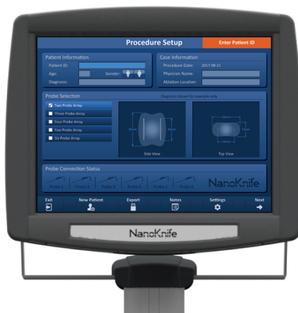
Rysunek 3.7.1: Ekran dotykowy LCD generatora NanoKnife
