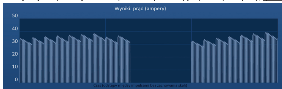
Rysunek 8.7.27: Wykres wartości natężenia prądu po pominięciu pary sond
