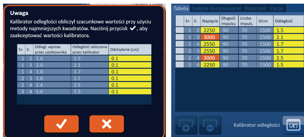
Rysunek 7.7.5: Wyniki kalibratora odległości i tabela parametrów impulsów
