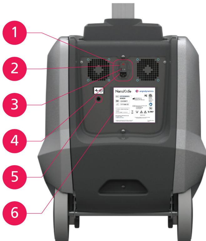
Rysunek 3.4.1: Zasilacz generatora NanoKnife — elementy na dolnym tylnym panelu
