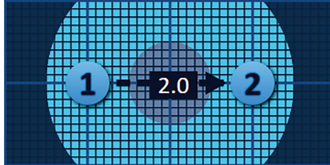
Figur 7.2.2: Rutenett for sondeplassing – polaritetspil
