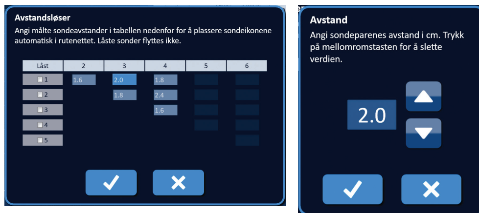
Figur 7.7.3: Avstandsløser – popup-vinduet for sondeparavstand
