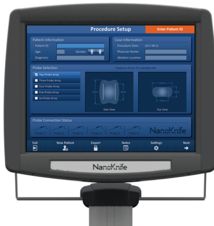
그림 3.7.1: NanoKnife 제너레이터 터치스크린 LCD 디스플레이
