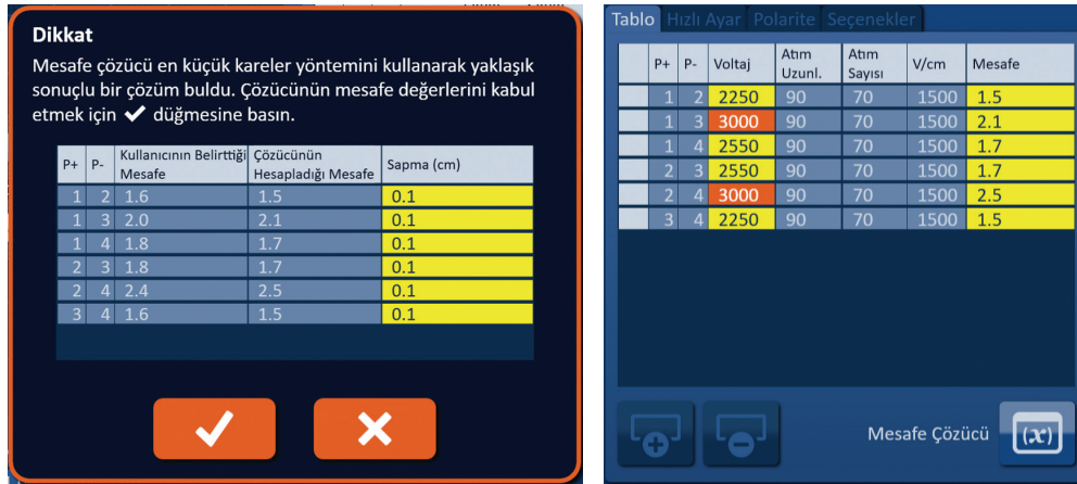
Şekil 7.7.5: Mesafe Çözücü Sonuçları ve Atım Parametreleri Tablosu
