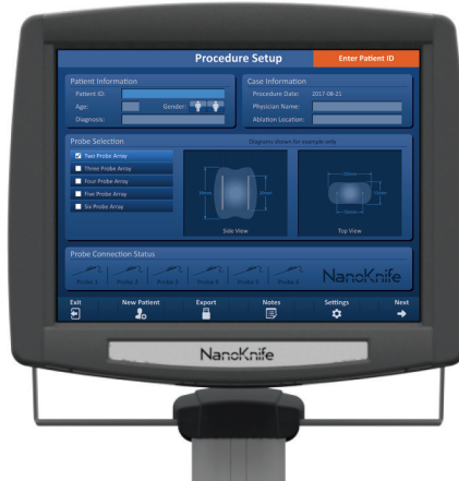
Şekil 3.7.1: NanoKnife Jeneratörü Dokunmatik LCD Ekran
