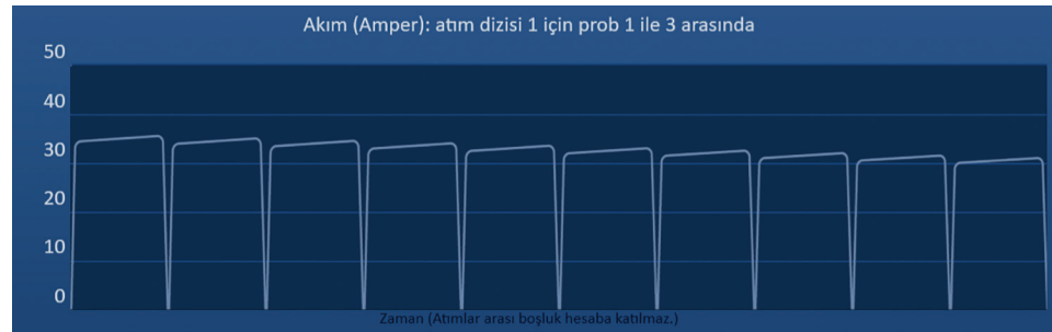
Şekil 8.4.6: Elektriksel Sonuçlar Çizelgesi – Bir Atım Dizisi
