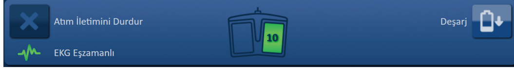
Şekil 8.7.15: Çift Ayak Pedalı Simgesi - Sağ Pedal Işığı Yanıyor
