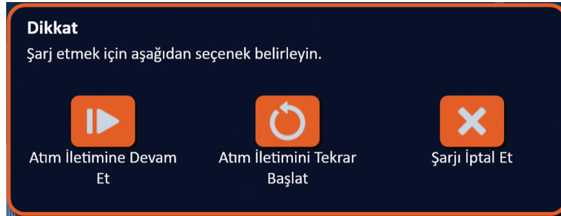
Şekil 8.7.22: Şarj Seçenekleri Açılır Penceresi – Atım İletiminin Ortasında
