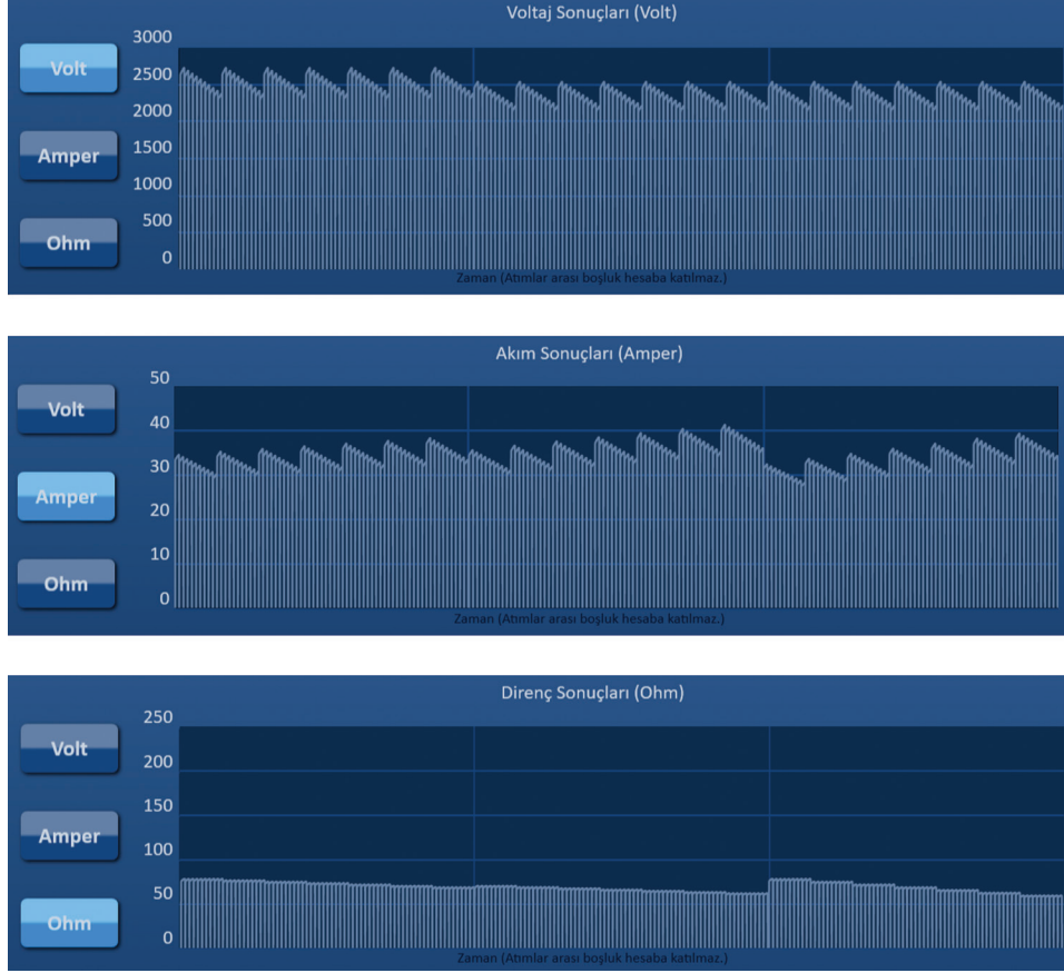
Şekil 8.4.2: Elektriksel Sonuçlar Çizelgeleri
