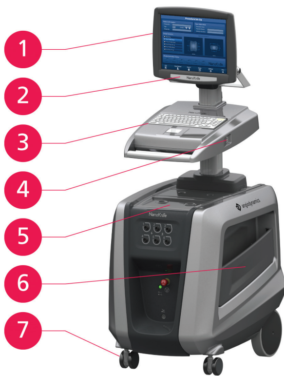
Figura 3.2.1: Generator NanoKnife – Componente din partea anterioară laterală
