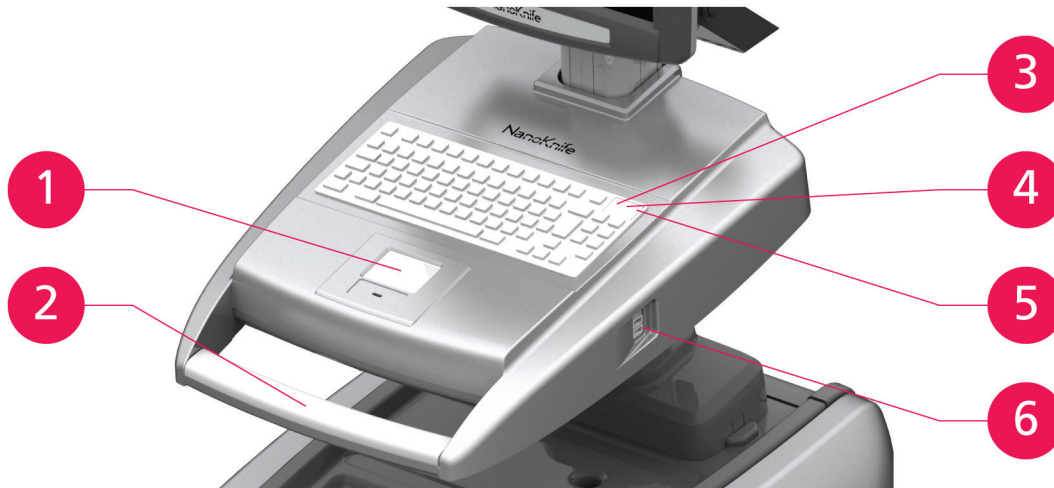
Slika 3.8.1: Komponente konzole NanoKnife generatora
