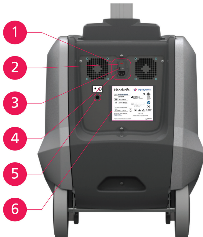
Slika 3.4.1: Napajanje NanoKnife generatora – komponente na donjoj zadnjoj tabli
