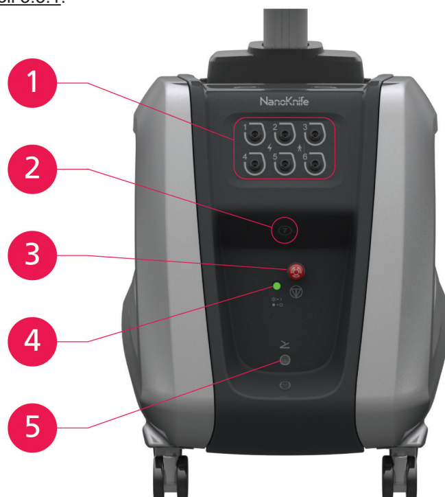
Slika 3.3.1: NanoKnife generator – komponente na donjoj prednjoj tabli
