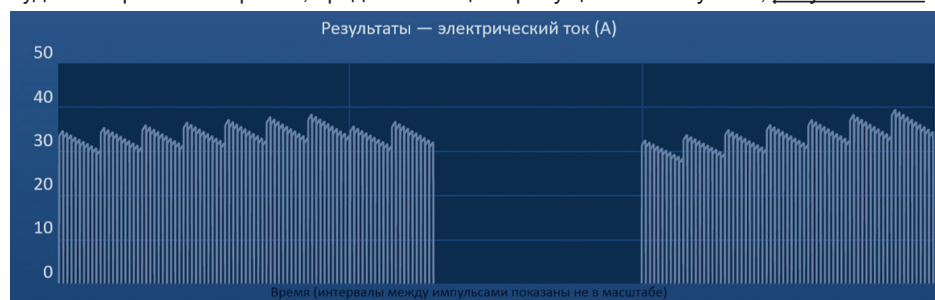
Рисунок 8.7.27. Диаграмма результатов тока после пропуска пары зондов
