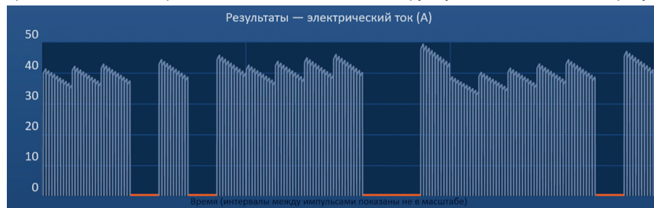
Рисунок 8.7.32. Диаграмма результатов тока после обнаружения сильного тока
