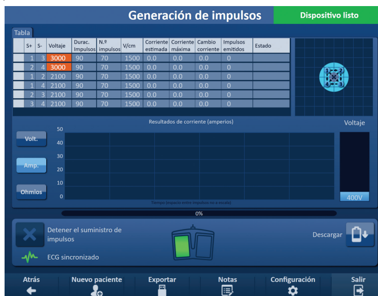
Figura 8.1.1: Pantalla Generación de impulsos
