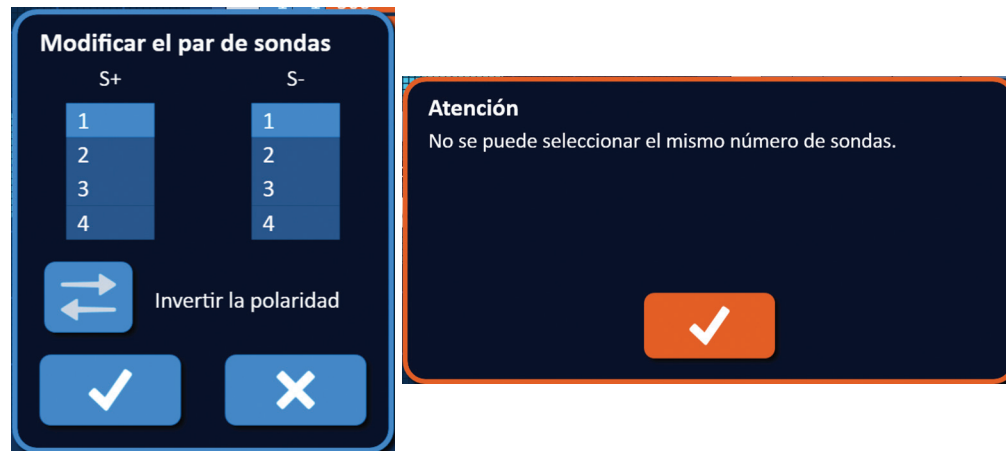
Figura 7.5.5: Ventana emergente de atención (valor de sonda idéntico)
