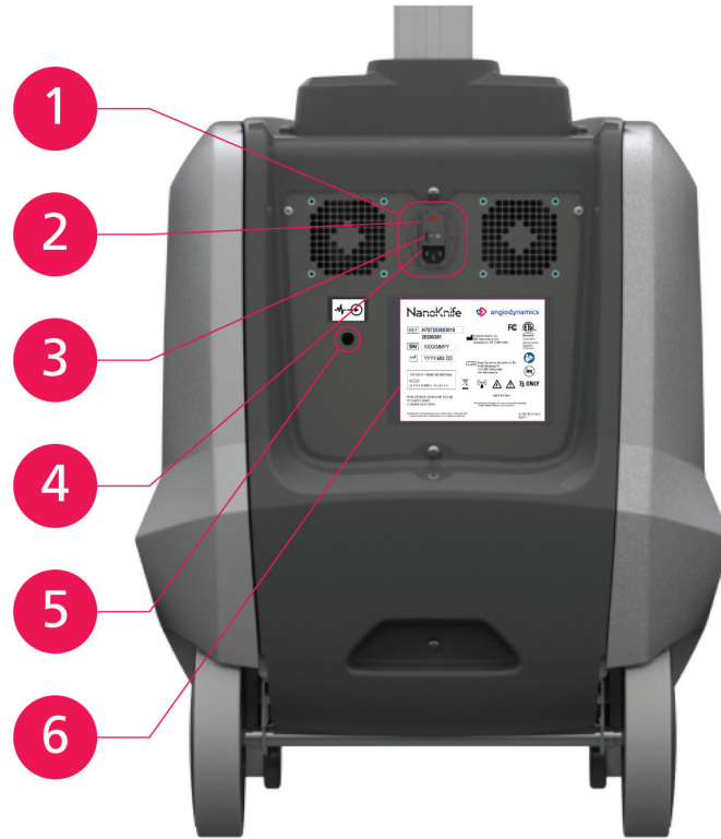
Figura 3.4.1: Unidad de alimentación del generador NanoKnife: componentes de la parte trasera inferior
