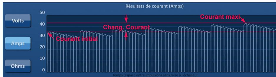
Figure 8.2.9 : Courant initial, maximal et changement de courant
