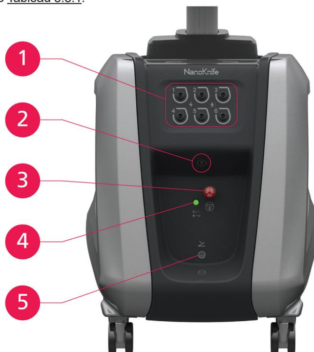
Figure 3.3.1 : Générateur NanoKnife – Composants à l'avant, en bas
