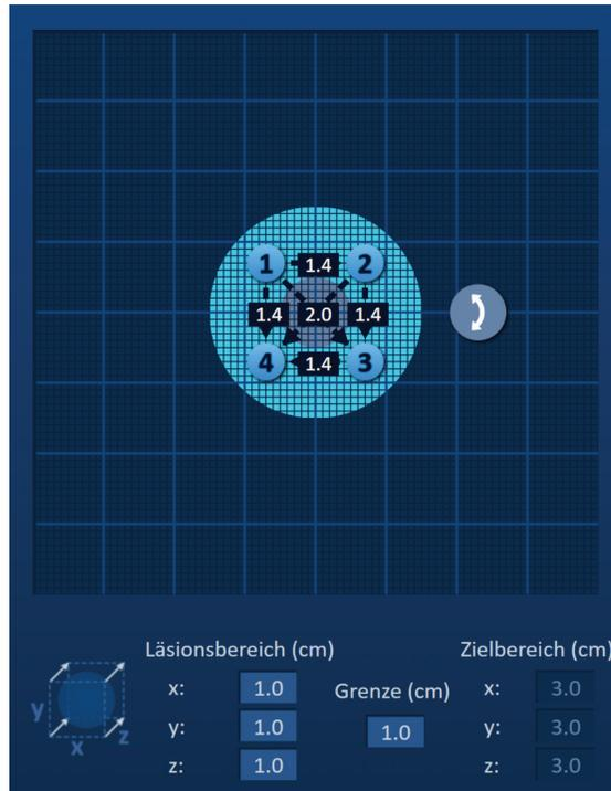
**Abbildung 7.3.1: Einstellungen für den Ablationszielbereich und Raster zur Sondenplatzierung**
