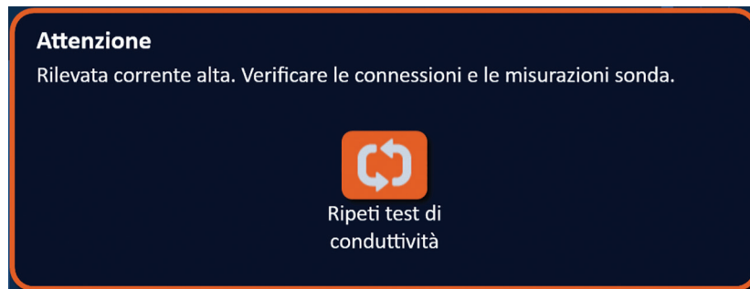
Figura 8.7.9: Test di conduttività - Popup Rilevata corrente alta.
