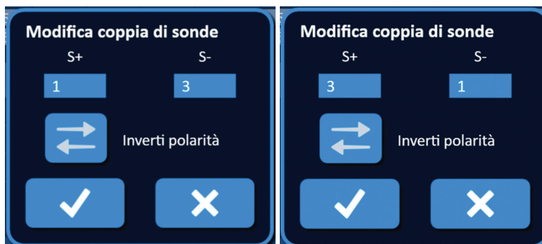
Figura 8.2.4: Inversione della polarità di una coppia di sonde
