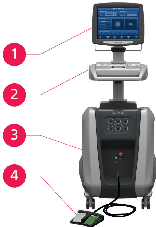
Figura 3.1.1: Generatore NanoKnife - Componenti principali
