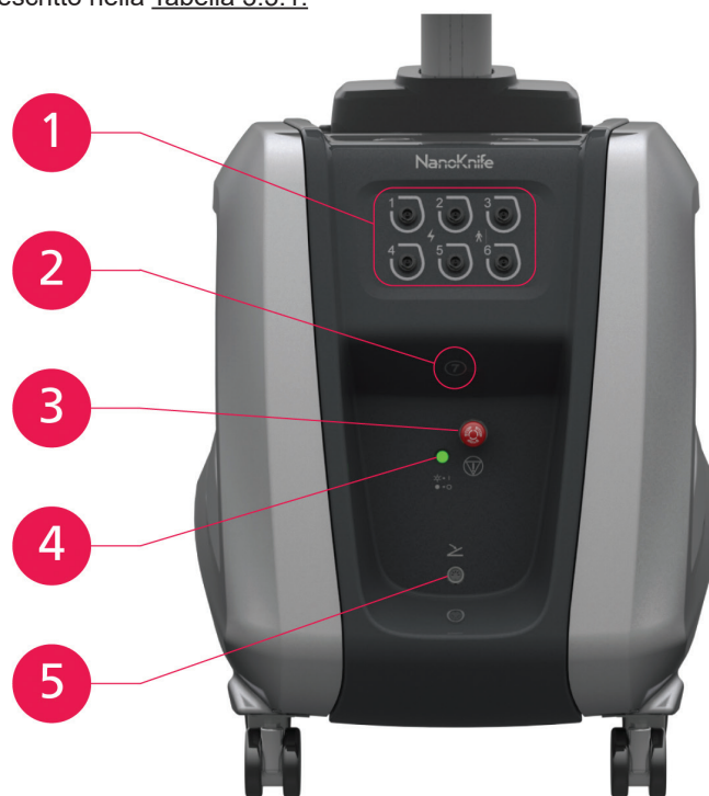
Figura 3.3.1: Generatore NanoKnife – Componenti del pannello anteriore/inferiore
