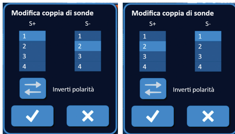
Figura 7.5.7: Inversione della polarità di una coppia di sonde
