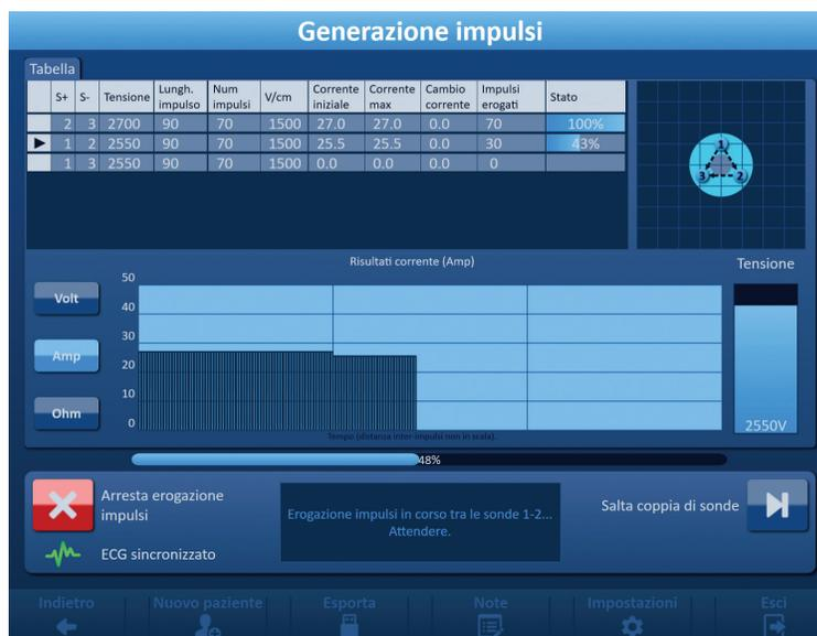
**Figura 8.7.18: Schermata Generazione impulsi durante l'erogazione degli impulsi**
