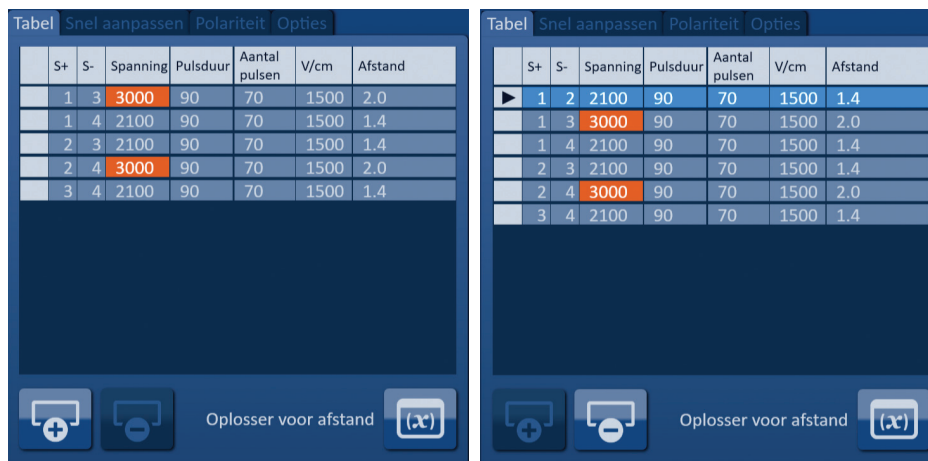
Afbeelding 7.6.3: Rij aan de tabel met pulsparameters toevoegen
