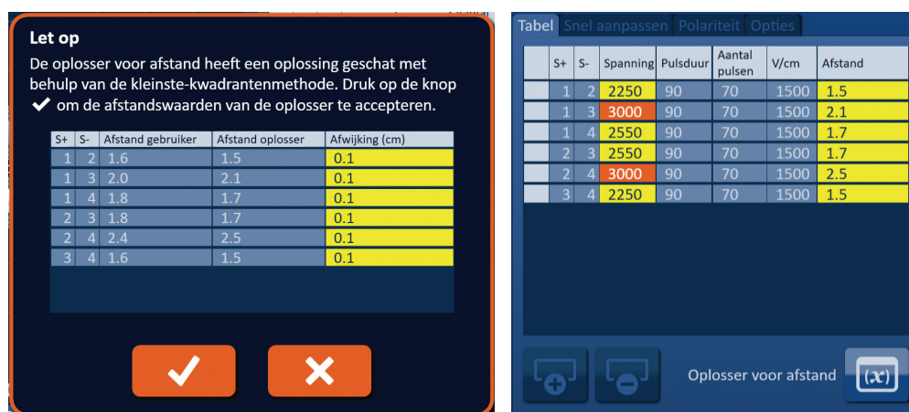
Afbeelding 7.7.5: Resultaten van de Oplosser voor afstand en de tabel met pulsparameters
