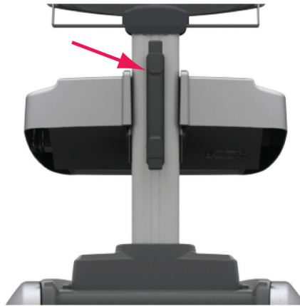
Afbeelding 3.5.1: Achterste handgreep van de NanoKnife-generator
