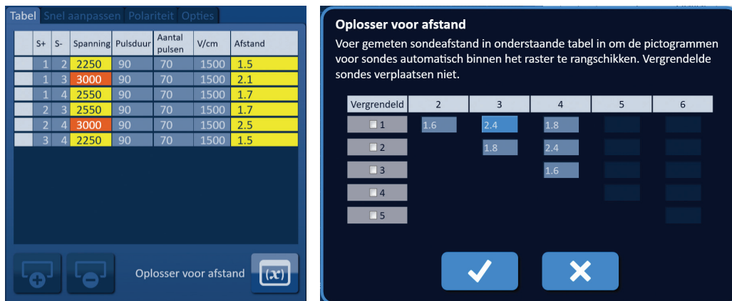
Afbeelding 7.7.2: Tabel met pulsparameters en de Oplosser voor afstand
