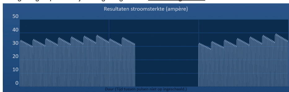
Afbeelding 8.7.27: De grafiek van de gemeten stroomsterkte nadat een sondepaar is overgeslagen
