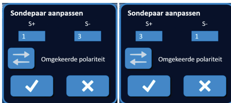
Afbeelding 8.2.4: De polariteit van het sondepaar omkeren
