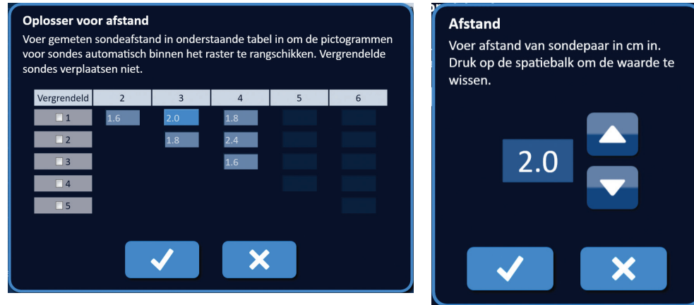
Afbeelding 7.7.3: Oplosser voor afstand – Het pop-upvenster Afstand voor het sondepaar
