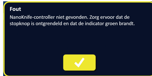
Afbeelding 4.2.3: Foutmelding van de opstartzelftest
