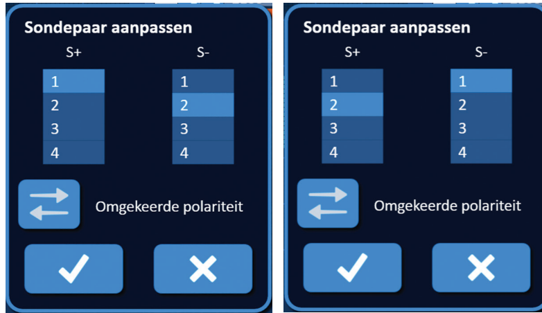
Afbeelding 7.5.7: De polariteit van het sondepaar omkeren
