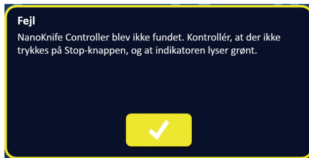
Figur 4.2.3: Pop op-vindue med fejl i startselvtest
