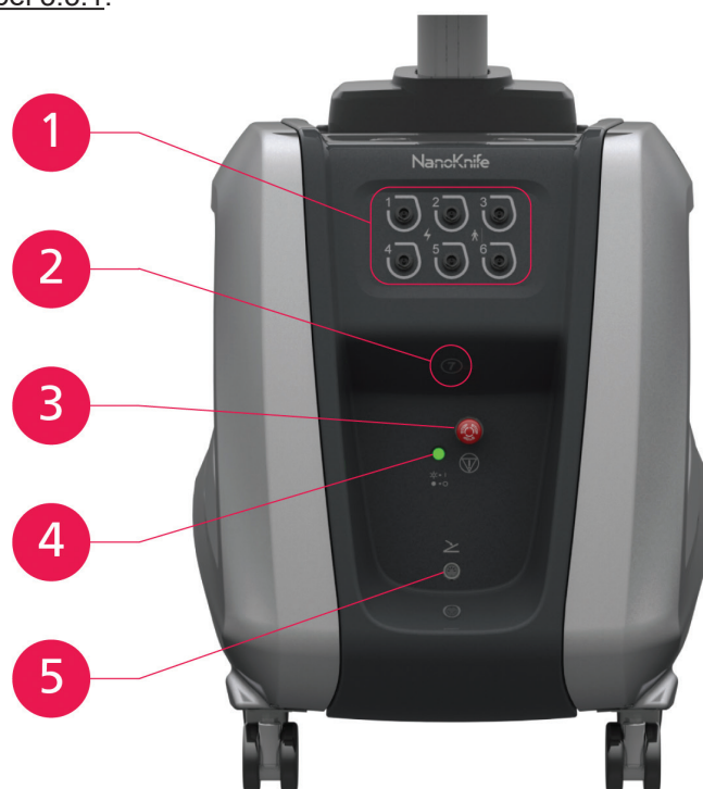
Figur 3.3.1: NanoKnife-generator – komponenter nederst på forsiden
