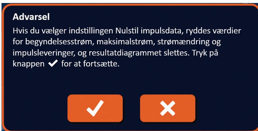
Figur 8.7.24: Pop op-vindue med advarslen Nulstil impulsdata
