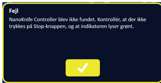
Figur 4.2.3: Pop op-vindue med fejl i startselvtest
