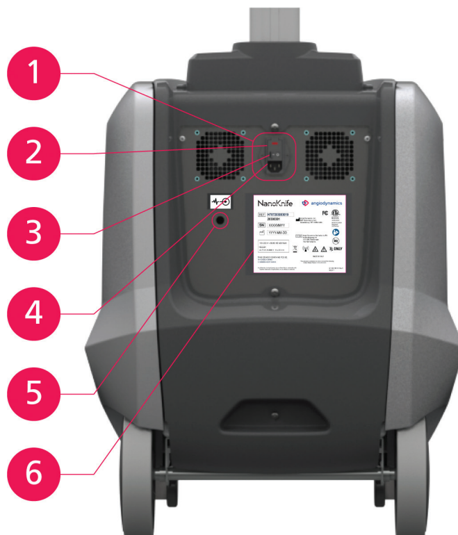
Figur 3.4.1: Strømenhed til NanoKnife-generatoren – komponenter nederst på bagsiden
