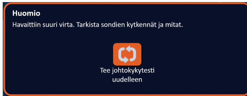
Kuva 8.7.9: Johtokykytesti – Havaittiin suuri virta -pönnahdusikkuna
