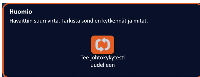
Kuva 8.7.9: Johtokykytesti – Havaittiin suuri virta -pönnahdusikkuna
