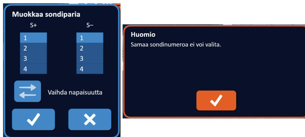
Kuva 7.5.5: Huomio-ponnahdusikkuna – sama sondiarvo
