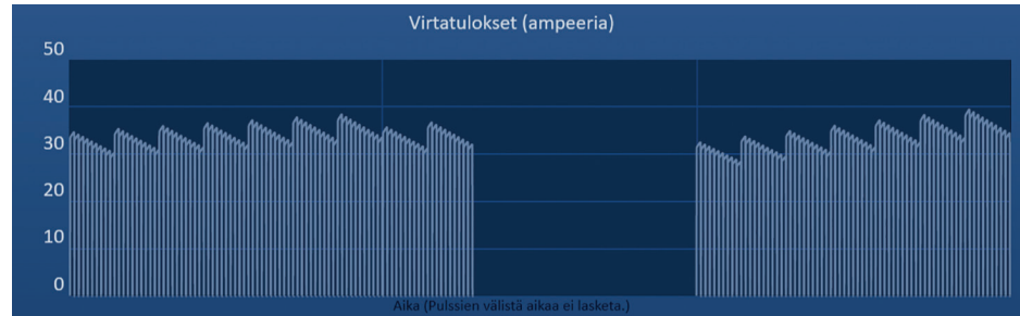
Kuva 8.7.27: Virtatulokset-kaavio sondiparin ohittamisen jälkeen
