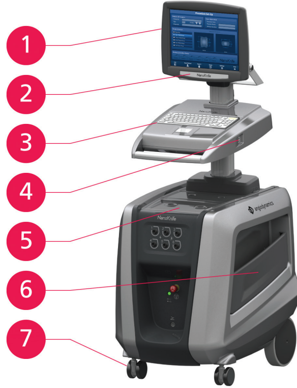
Kuva 3.2.1: NanoKnife-generaattori – komponentit edessä oikealla puolella
