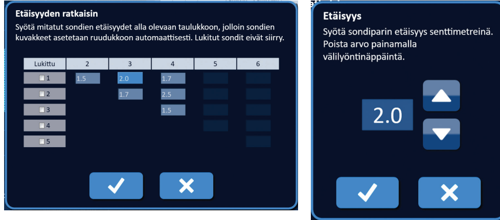
Kuva 7.7.3: Etäisyyden ratkaisin – sondiparin etäisyyden ponnahdusikkuna
