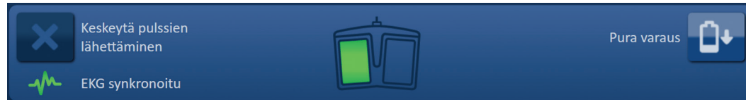
Kuva 8.7.2: Kahdella polkimella varustetun jalkakytkimen kuvake – vasen poljin vihreänä
