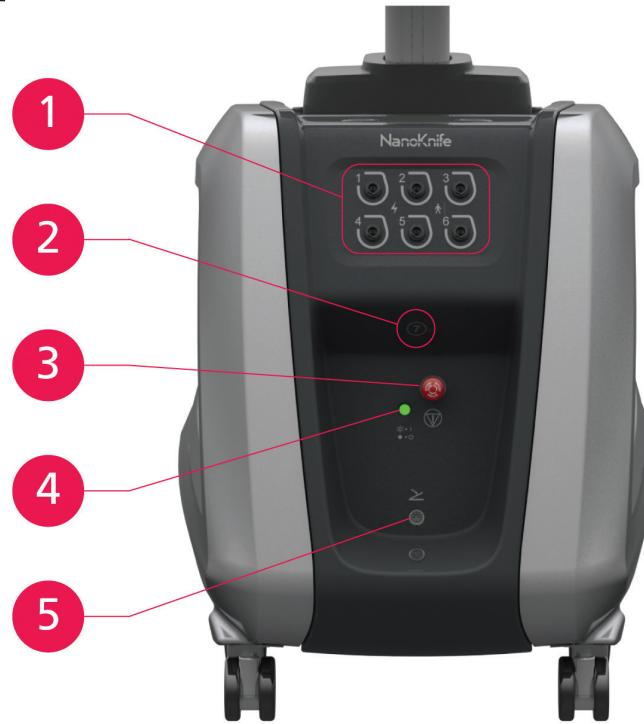
Kuva 3.3.1: NanoKnife-generaattori – komponentit edessä alhaalla
