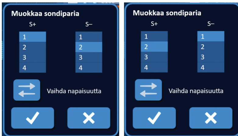
Kuva 7.5.7: Sondiparin napaisuuden vaihtaminen
