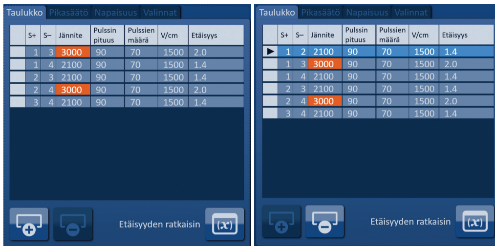
Kuva 7.6.3: Rivin lisääminen pulssiparametritaulukoon
