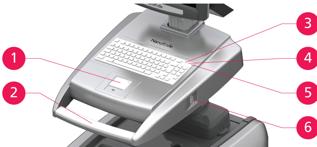
Фигура 3.8.1: Компоненти на конзолата на генератора NanoKnife
