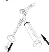
Fixe e purgue o conector em Y (Fig. 4) com o adaptador Tuohy-Borst colocando um polegar sobre a porta de passagem, ao mesmo tempo que infunde soro fisiológico pela porta lateral. Fixe uma seringa de 1 ml na porta de passagem e aspire 0,5 ml de soro fisiológico. Separe a seringa de 1 ml e elimine as bolhas da seringa. Faça levantar um êmbolo (Fig. 5) na porta de passagem pressionando devagar o êmbolo da seringa-reservatório. Volte a fixar a seringa de 1 ml na porta de passagem.
